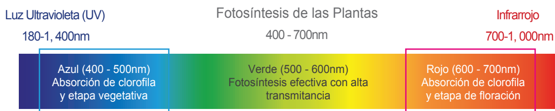
Figura 2. Efectos de las Longitudes de Onda en el Crecimiento de las Plantas
